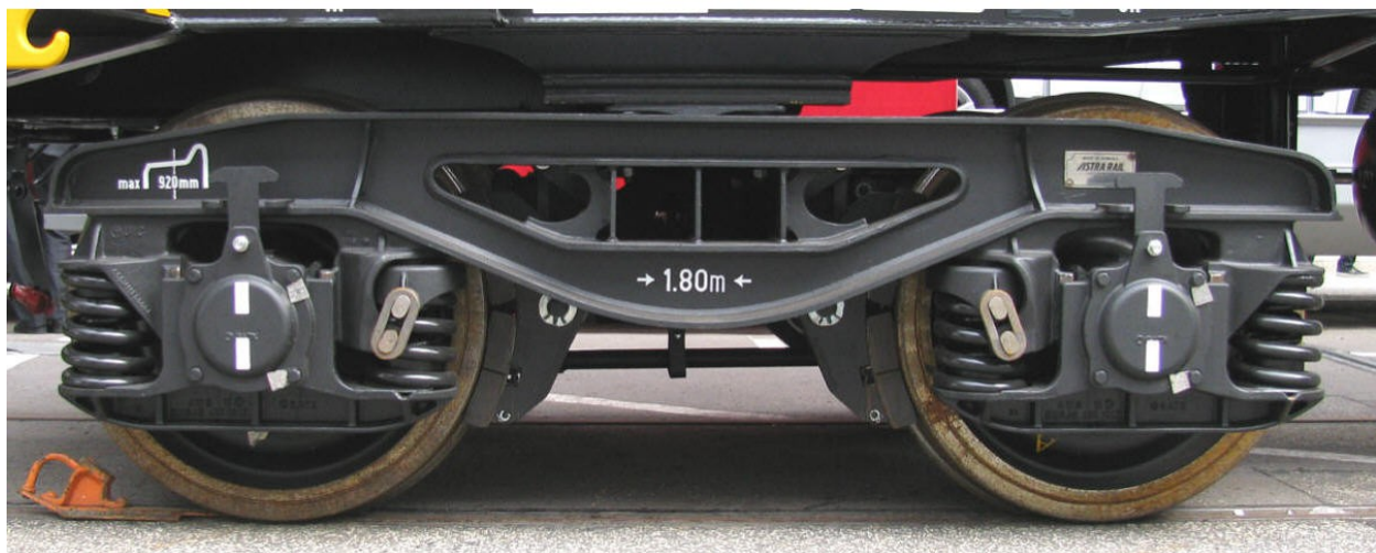
Güterwagen-Drehgestell Astra Y25Lsd-KP1, gesehen auf dem Freigelände unter 37 TEN-RIV 84 NL-GATXD 7830 025-4 Zans 87 /m 3 Freight Car Bogie Astra Y25Lsd-KP1, seen at outdoor display with 37 TEN-RIV 84 NL-GATXD 7830 025-4 Zans 87 /m 3
